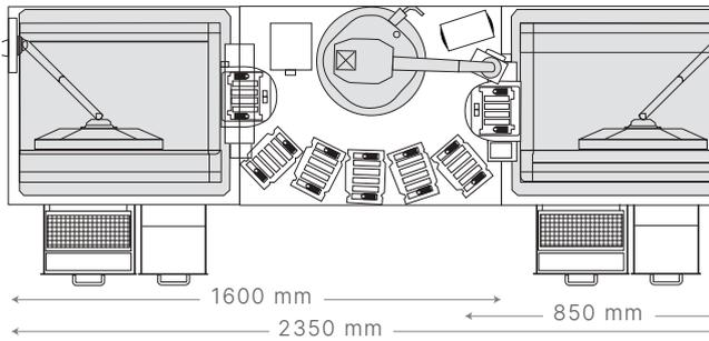
Figura 2. Esempio di configurazione da banco per Dual iScanDx Instrument più AutoLoader 2.x. Due iScanDx Instrument con AutoLoader 2.x possono essere facilmente inseriti su un tipico banco da laboratorio. L'altezza del sistema, monitor escluso, è di 510 mm. Sono possibili anche altre configurazioni.
