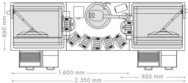
Abbildung 2: Beispiel einer Tischkonfiguration für zwei iScanDx Instrument-Geräte mit Autoloader 2.x: Zwei iScanDx Instrument-Geräte und der AutoLoader 2.x passen problemlos auf einen typischen Labortisch. Die Höhe des Systems ohne Bildschirm beträgt 510 mm. Andere Konfigurationen sind ebenfalls möglich.
