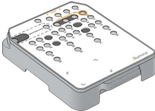
La cartuccia di reagenti comprende un serbatoio designato al caricamento delle librerie preparate. Dopo l'avvio della corsa, le librerie vengono trasferite automaticamente dal serbatoio alla cella a flusso. Diversi serbatoi sono riservati per il lavaggio post-corsa automatico. La soluzione di lavaggio viene pompata dalla cartuccia di tamponi nei serbatoi riservati, attraverso il sistema, quindi al contenitore dei reagenti usati.
