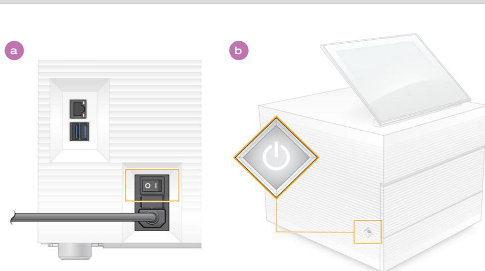
**a** Ligue o interruptor da parte de trás do instrumento, colocando-o na posição (I).
