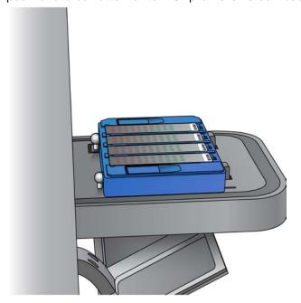
Se il porta-BeadChip si muove in avanti e indietro dopo che è stato posizionato sul vassoio, iScan Reader centra e posiziona automaticamente i BeadChip per la corretta scansione.
