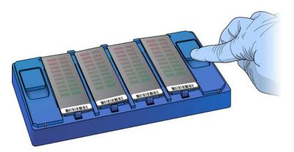
c. Se un qualsiasi BeadChip non è ancora livellato, premere e rilasciare di nuovo il pulsante di sollevamento. Se è ancora necessario regolare i BeadChip, regolarli manualmente. Manipolare i BeadChip solo per i bordi.
