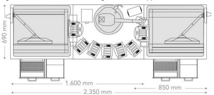
Figura 3 Dimensioni di una configurazione a doppio scanner con AutoLoader 2.x
