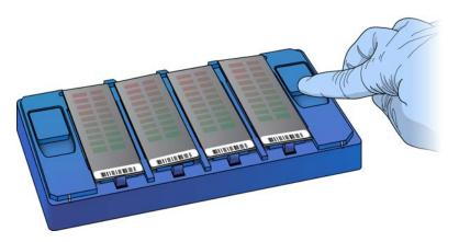
c. Si une puce BeadChip n'est toujours pas parfaitement à plat, appuyez de nouveau sur le bouton de levée et relâchez-le. Si d'autres ajustements sont requis, ajustez manuellement les puces BeadChip. Manipulez les puces BeadChip uniquement par les bords.
