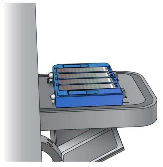
Lorsque le support se déplace vers l'avant et l'arrière une fois dans le plateau, le lecteur iScan centre et positionne automatiquement les puces BeadChip pour que le balayage s'effectue correctement.
