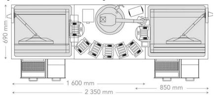
Figure 3 Dimensions d'une configuration à deux scanners avec AutoLoader 2.x
