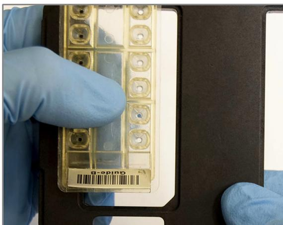
**Рис. 135** Установка вставки в рамку направляющей для дозаторов робота
