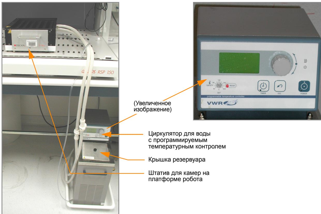
**Рис. 63** Циркулятор для воды, подключенный штативу для камер
