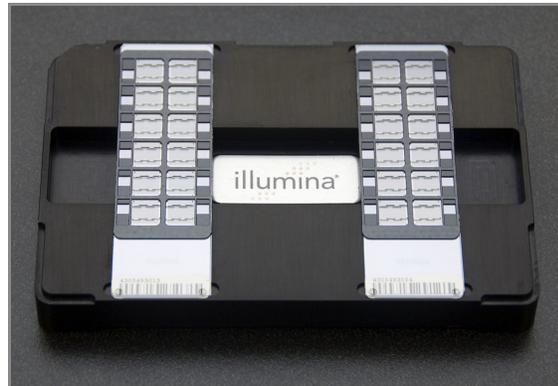
Рис. 147 Установка чипов BeadChip в центрирующее устройство, обрабатываемое роботом
