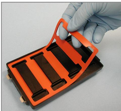
**Рис. 36** Установка прокладки в гибридационную камеру
