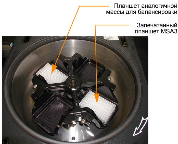
Рис. 125 Балансировка планшета MSA3 в центрифуге
