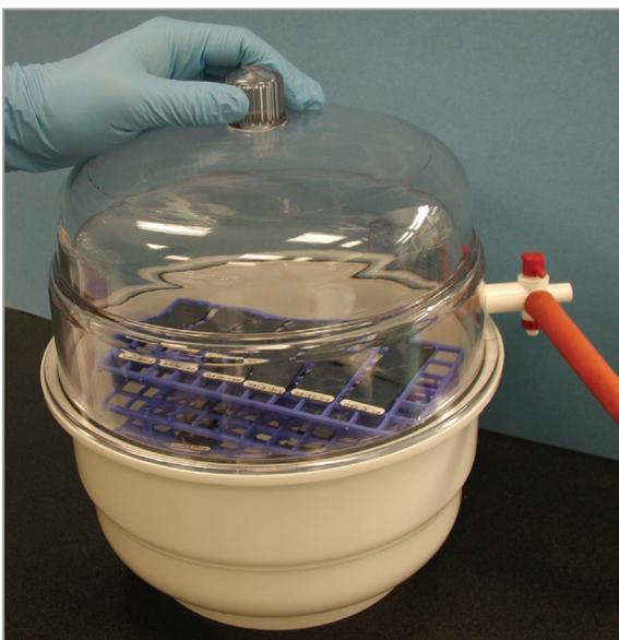
Рис. 199 Проверка прилегания крышки эксикатора
