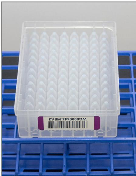
Рис. 126 Непокрытый планшет MSA3, перевернутый для воздушной просушки
