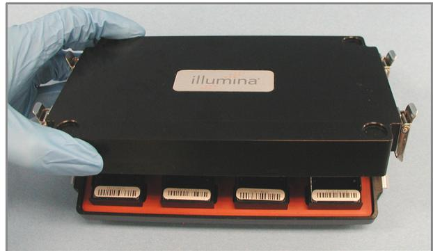
**Рис. 154** Установка крышки на гибридную камеру
