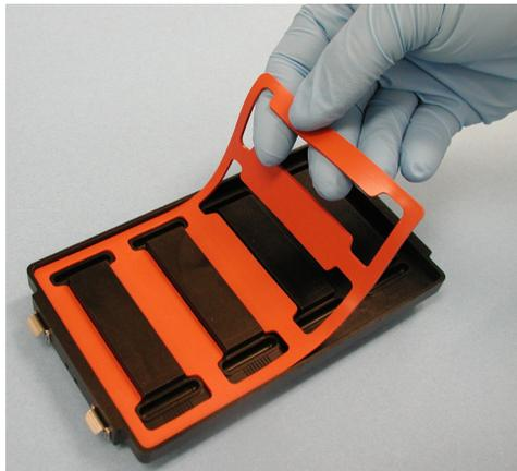
**Рис. 141** Установка прокладки в гибридную камеру
