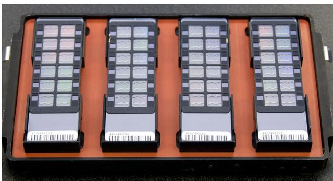
Рис. 45 Установка вставок в гибридизационную камеру
