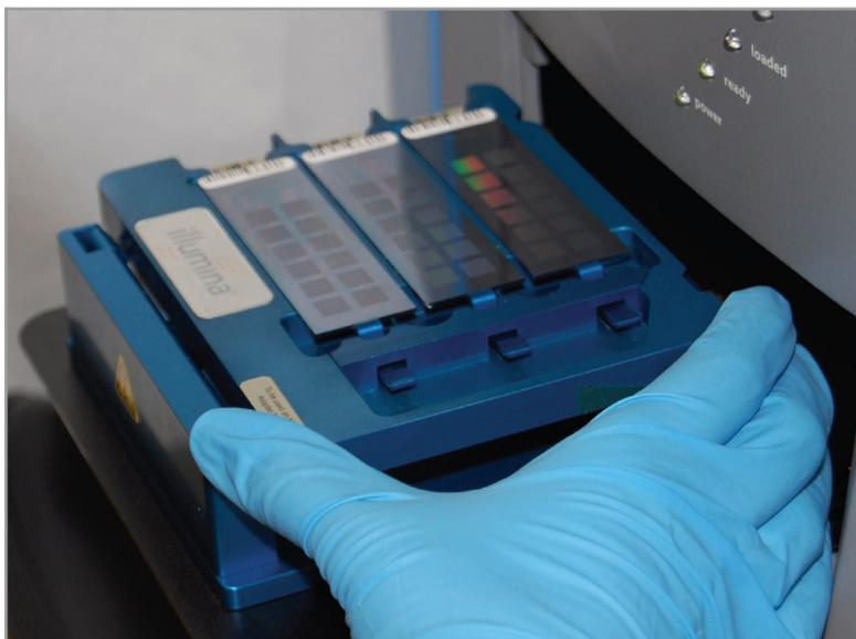
**Рис. 216** Поместите чип BeadChip в поддон Сканер Illumina BeadArray Reader.
