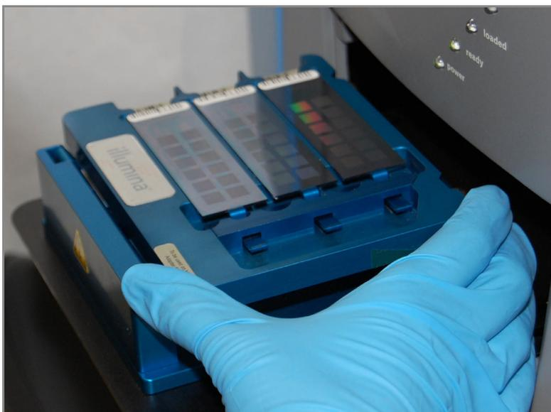
**Рис. 92** Поместите чип BeadChip в поддон Сканер Illumina BeadArray Reader.
