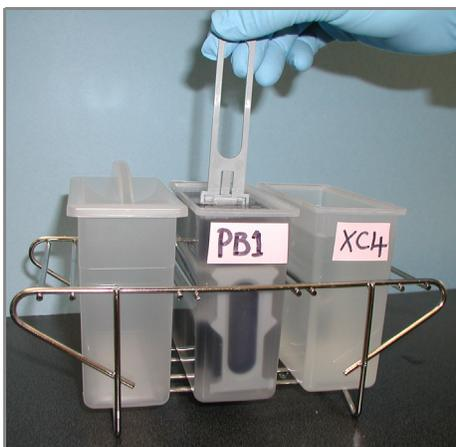
Рис. 183 Промывка чипов BeadChip в РВ1
