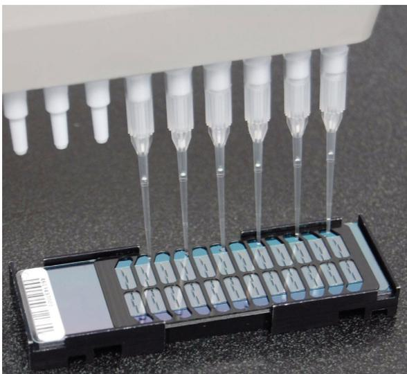
**Рис. 41** Загрузка образцов (для чипа 24x1 HD BeadChip)
