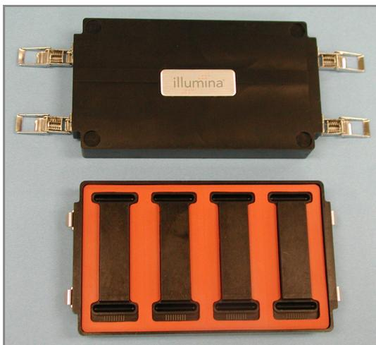
**Рис. 37** Гибридационная камера с установленной прокладкой
