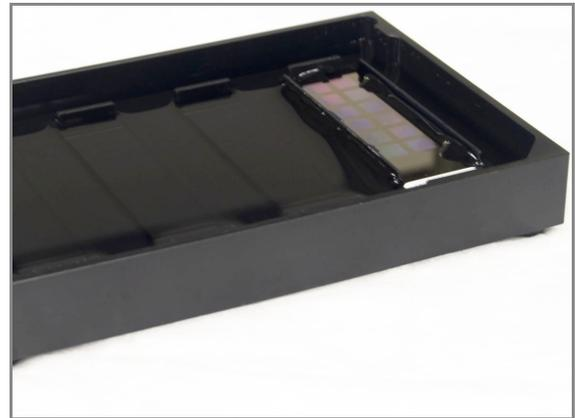
**Рис. 55** Установка чипа BeadChip в черную рамку, закрепленную в центрирующем устройстве
