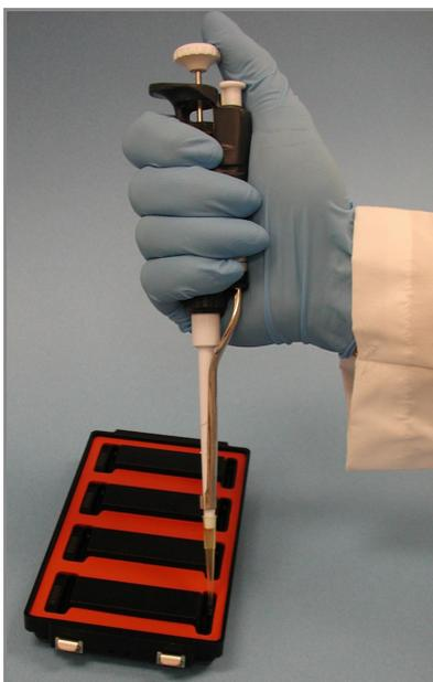
*Рис. 143* Дозирование PB2 в резервуары гибридационной камеры
