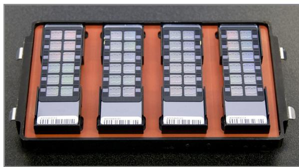
*Рис. 153 Установка чипов BeadChips в гибридационную камеру*
