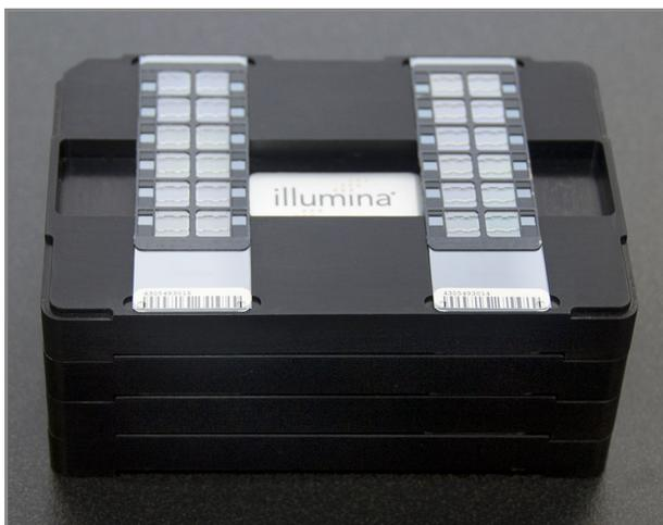
Рис. 148 Стопка из четырех центрирующих устройств для чипов BeadChip, обрабатываемых роботом
