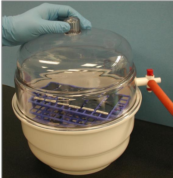
*Рис. 75 Проверка прилегания крышки эксикатора*
