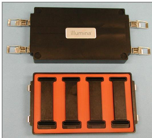
**Рис. 142** Гибридная камера с установленной прокладкой
