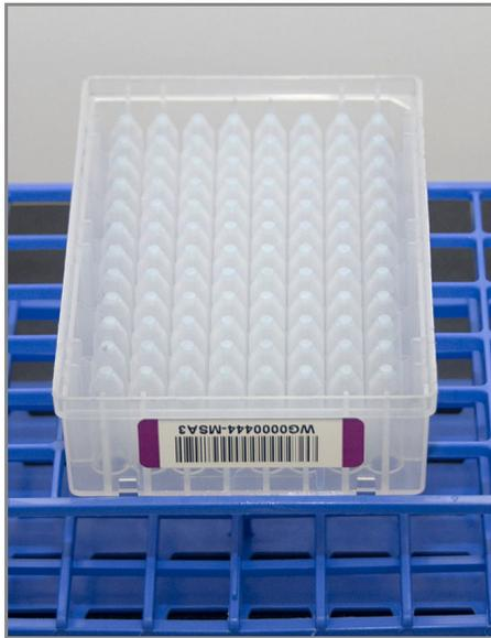
**Рис. 31** Непокрытый планшет MSA3, перевернутый для воздушной просушки
