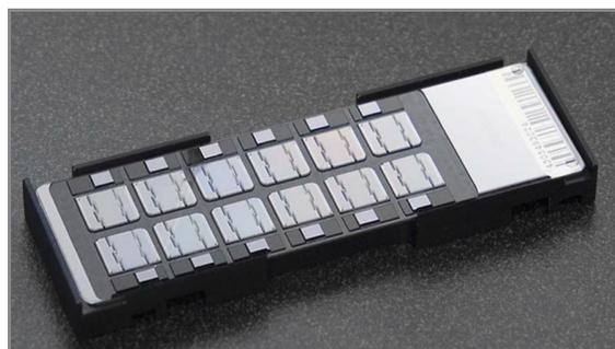
**Рис. 40** Установка чипов BeadChip во вставки гибридационной камеры
