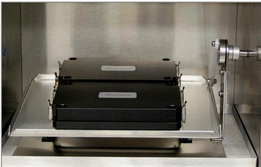
*Рис. 156* Правильное размещение двух гибридационных камер в гибридационной печи
