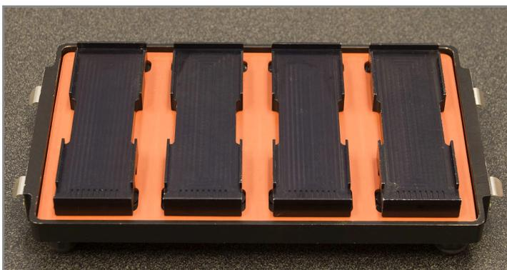
*Рис. 152 Вставки, установленные в гибридационную камеру*
