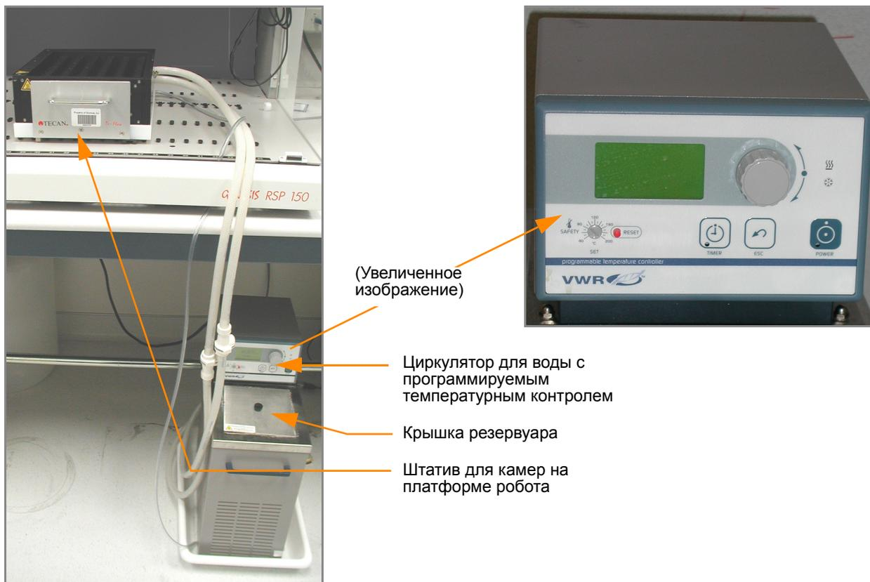
Рис. 172 Циркулятор для воды, подключенный штативу для камер
