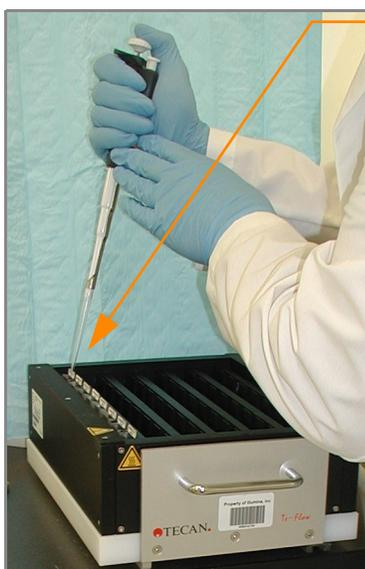
Наконечник пипетки не должен касаться поверхности чипа BeadChip
