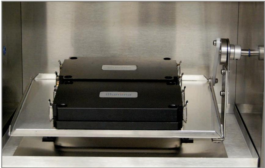
*Рис. 48* Правильное размещение двух гибридационных камер в гибридационной печи
