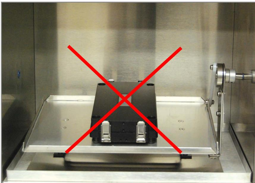
*Рис. 157* Неправильное размещение гибридационной камеры
