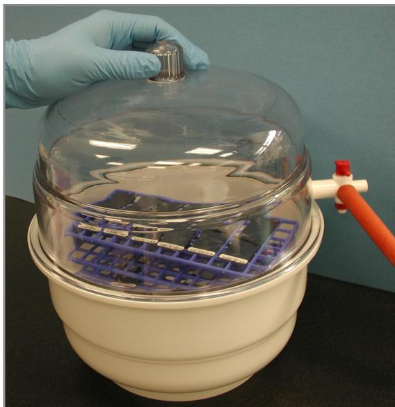
*Рис. 189* Проверка прилегания крышки эксикатора
